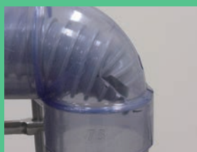
加工部が縮む事でエルボの下まで挿入しやすい
